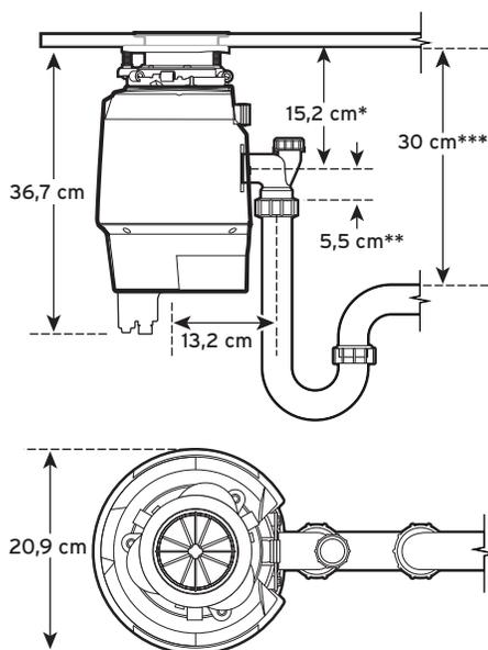
\*Distância do fundo da pia até a linha central da saída do triturador. Adicione 12,7 mm quando forem utilizadas pias de aço inoxidável.
